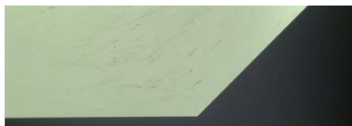
ミュラー面取りエンドミル 刃先× 2000 The edge of Muller End Mill for chamfering
