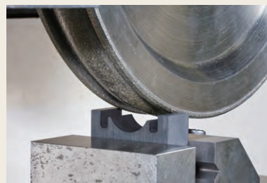
カーボンの総形加工 Forming of carbon
