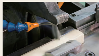
セラミックスの切断加工 Cutting of ceramics
